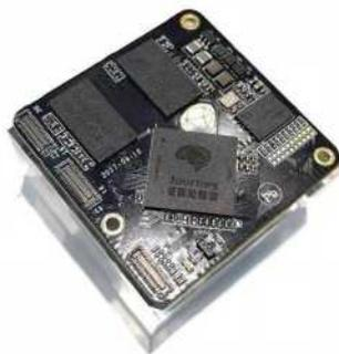
**征程（Journey）**：于2017年正式流片发布，可用于L2级别的辅助驾驶系统（ADAS）。具备同时对人、机动车、非机动车、车道线、交通标志牌、红绿灯等多类目进行精准的实时监测和识别的能力。
