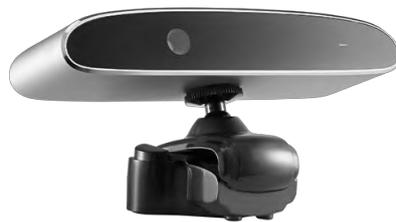
**头控仪：**适用于头部可以灵活移动的用户，通过头部运动控制鼠标对电脑进行操作。
